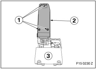
Schrauben (1) an Abdeckung (2) lösen.
