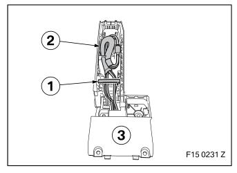
Leitungen (2) der Wireless-Charging Ablage **A** wie dargestellt verlegen und mit Halteclip (1) befestigen.
