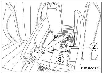
Torxschrauben (1) an Aufnahme (2) lösen.
