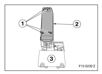
Abdeckung (2) mit Schrauben (1) befestigen.
