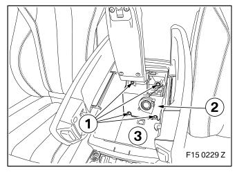
Aufnahme (2) einbauen und mit Schrauben (1) fixieren.
