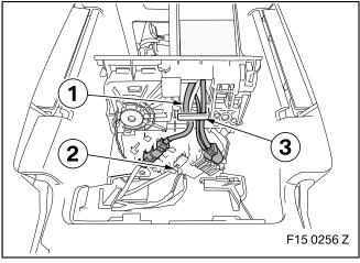
Stecker (1), Buchsengehäuse 18-pol. SW, und Buchsengehäuse 4-pol SW, der Wireless-Charging Ablage **A** wie dargestellt verlegen und an Fahrzeugseitige Stiftgehäuse anschließen.
