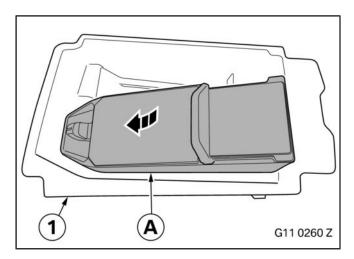
Wireless-Charging Ablage **A** in Ablagefach Mittelarmlehne (1) einbauen.
