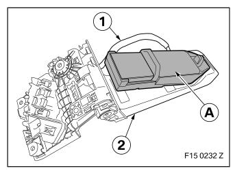
Leitungen (1) der Wireless-Charging Ablage **A** einfädeln.
